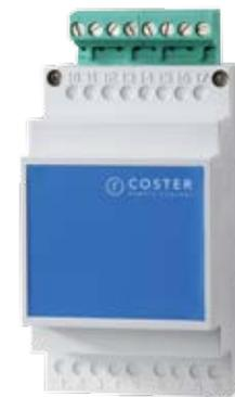
Modulo di espansione di ingressi analogici (sonde di temperatura), in grado di comunicare con le centraline YLC 740/880.
