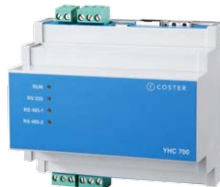
Network manager modbus dispositivo parte integrante della piattaforma per la regolazione e controllo di impianto Serie YLC e per sistemi di monitoraggio. Consente lo scambio dati tra il regolatore YLC 880 e il rilancio allarmi, permettendo l'accessibilità da remoto ai dispositivi in campo tramite MDM 232 o tramite cavo ethernet
