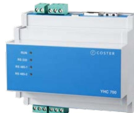
Network manager modbus dispositivo parte integrante della piattaforma per la regolazione e controllo di impianto Serie YLC e per sistemi di monitoraggio, WEB ACCESS CON LICENZA EMBEDDED DA 200 PUNTI. Mantiene le medesime caratteristiche di YHC 700, unendo i vantaggi della piattaforma di supervisione, integrata in un hardware di piccole dimensioni. Può contenere semplici grafiche personalizzate che consentono la consultazione dei dati attraverso un'interfaccia utente user friendly.
