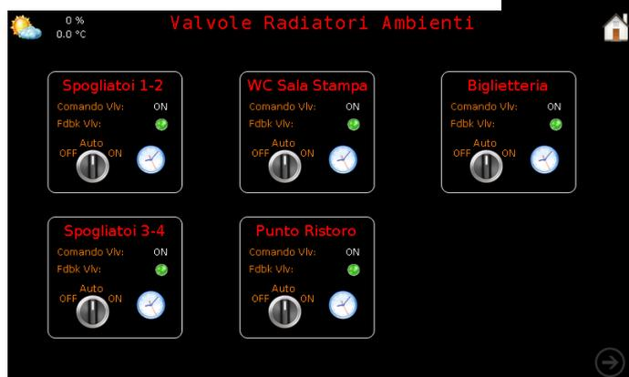
Un Touch Panel garantisce all'utente la possibilità di interagire, sia localmente che da remoto (tramite connessione del dispositivo alla rete LAN locale), con il sistema.
